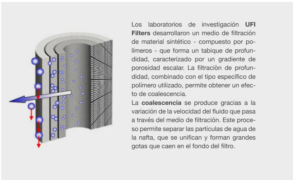
Los laboratorios de investigación **UFI Filters** desarrollaron un medio de filtración de material sintético - compuesto por polímeros - que forma un tabique de profundidad, caracterizado por un gradiente de porosidad escalar. La filtración de profundidad, combinado con el tipo específico de polímero utilizado, permite obtener un efecto de coalescencia.
